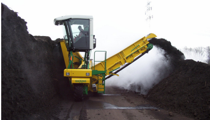
Mietenumsetzgerät. Linker Teil der Tafelmiere wird abgefräst und rechts neu aufgesetzt.
