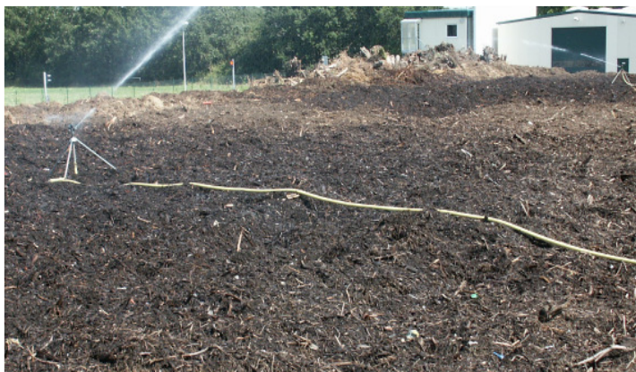
Sprenger auf der Mietenoberfläche zur Bewässerung der Mieten
