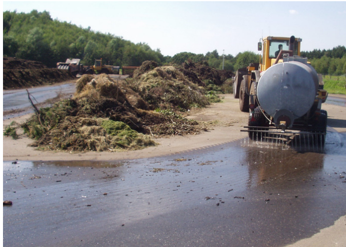
Besprengen der Freiflächen gegen Staub
