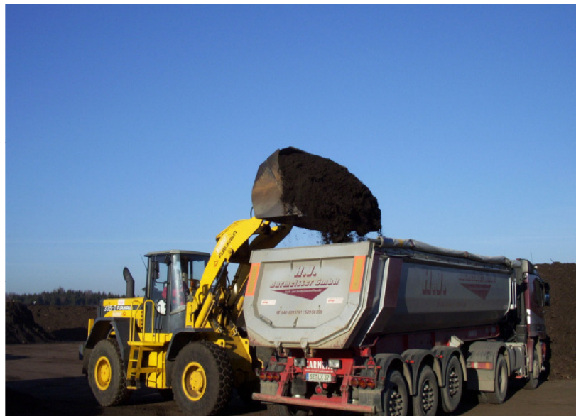
Verladen von Oberbodenmaterial (aus aufbereitetem Erdaushub und Kompost) für eine Baustelle
