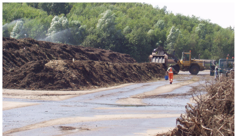
Aufsetzen einer neuen Charge an die bestehende Tafelmiete
