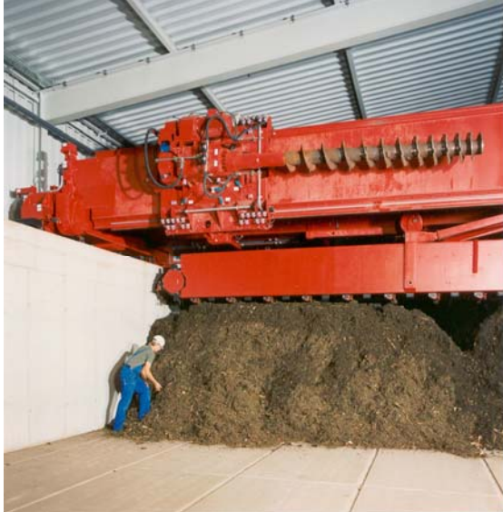
Mietenbearbeitung in der Rottehalle
