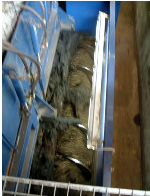
Spiralförderung und Mischung der Inputströme
