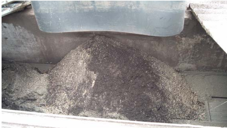
Tiefbunker mit vorabgesiebttem Grünabfall und Zumischung von Sägespänen
