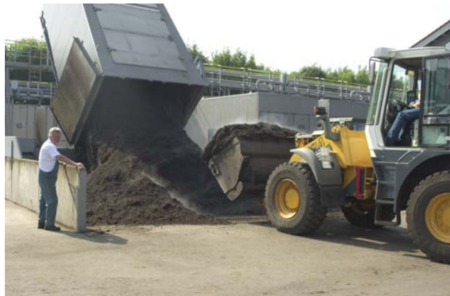
Entleeren der Container nach der Intensivrotte
