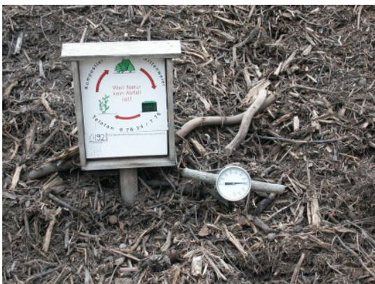
Abb. 6: Schild mit Chargenbezeichnung und manuelle Temperaturmessung.
