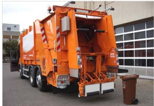
Abbildung 1: Sammelfahrzeug mit eingebauten Störstoffdetektoren an der Schüttung.
