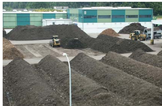
Technisch gesteuerte Rottebedingungen im Kompostwerk sichern die Abtötung von Krankheitskeimen und Unkrautsamen.
