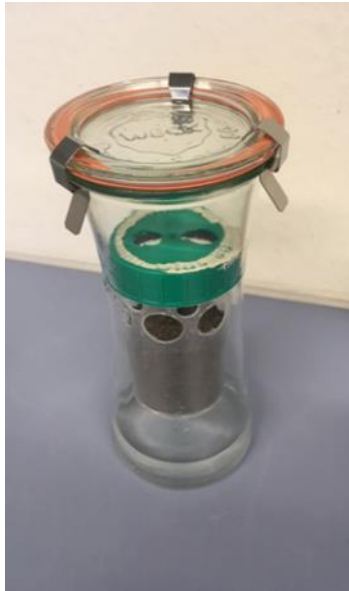
Abbildung 1: Quarzsand-Substrat-Gemisch im Innengefäß, freigesetztes \text{CO}_2 wird in der Natronlauge absorbiert.
