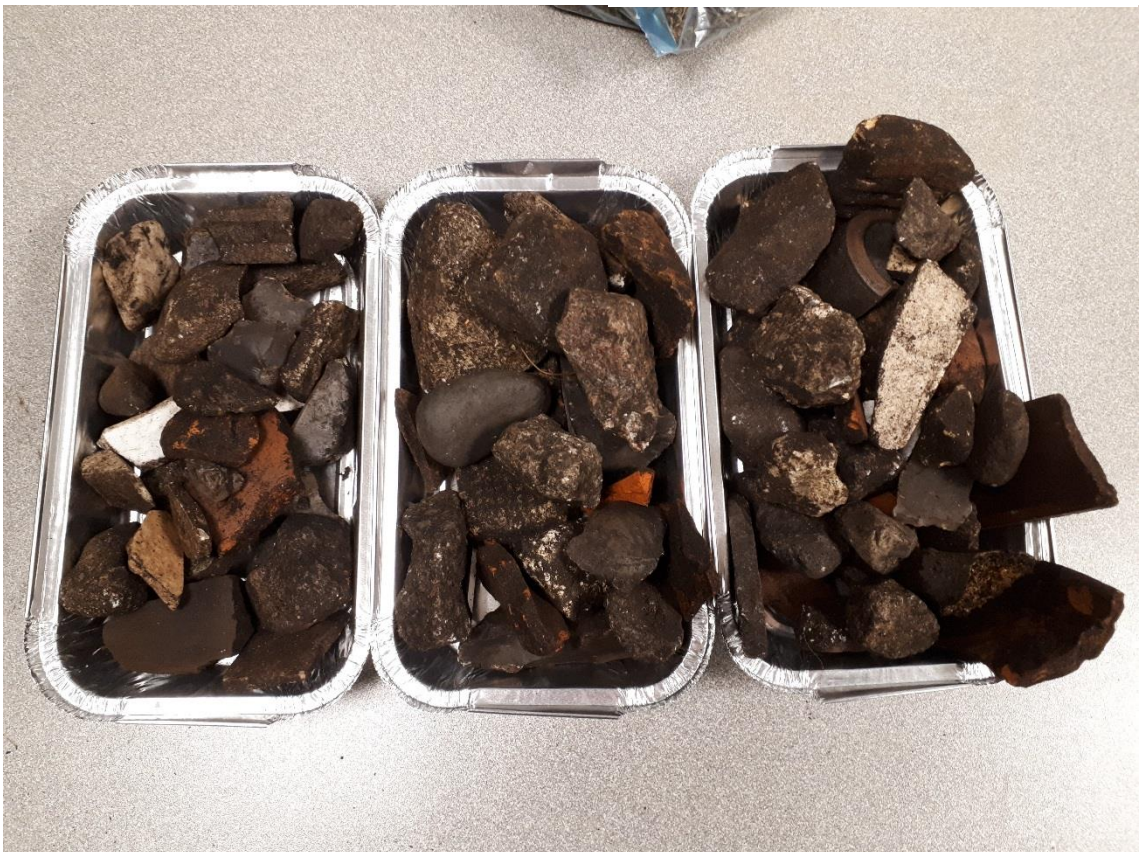
Abbildung 9-8: Steinfraction des Siebüberlaufes
