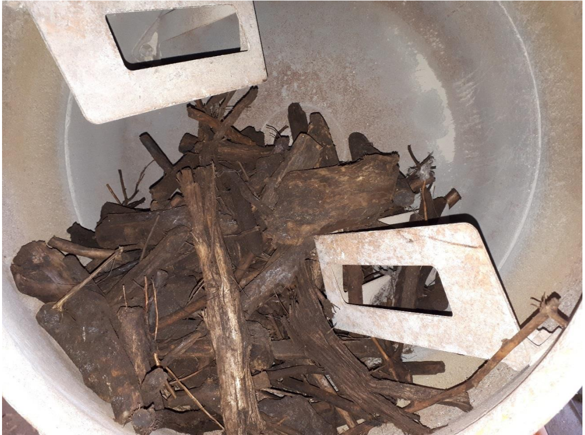
Abbildung 3-15: Versuchsaufbau 1: Mischtrommel mit zwei Schaufeln
