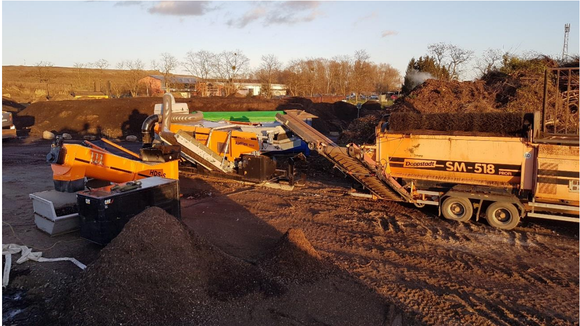
Abbildung 3-9: Gesamtansicht der Aufbereitung von Kompostsiebüberlauf Links: Schwimm-Sink-Sortierung; Mitte: Windsichter; Rechts: Trommelsieb
