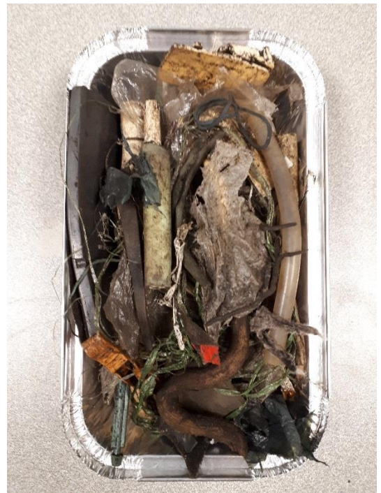
Abbildung 9-5: Kunststofffraktion des Siebüberlaufes
