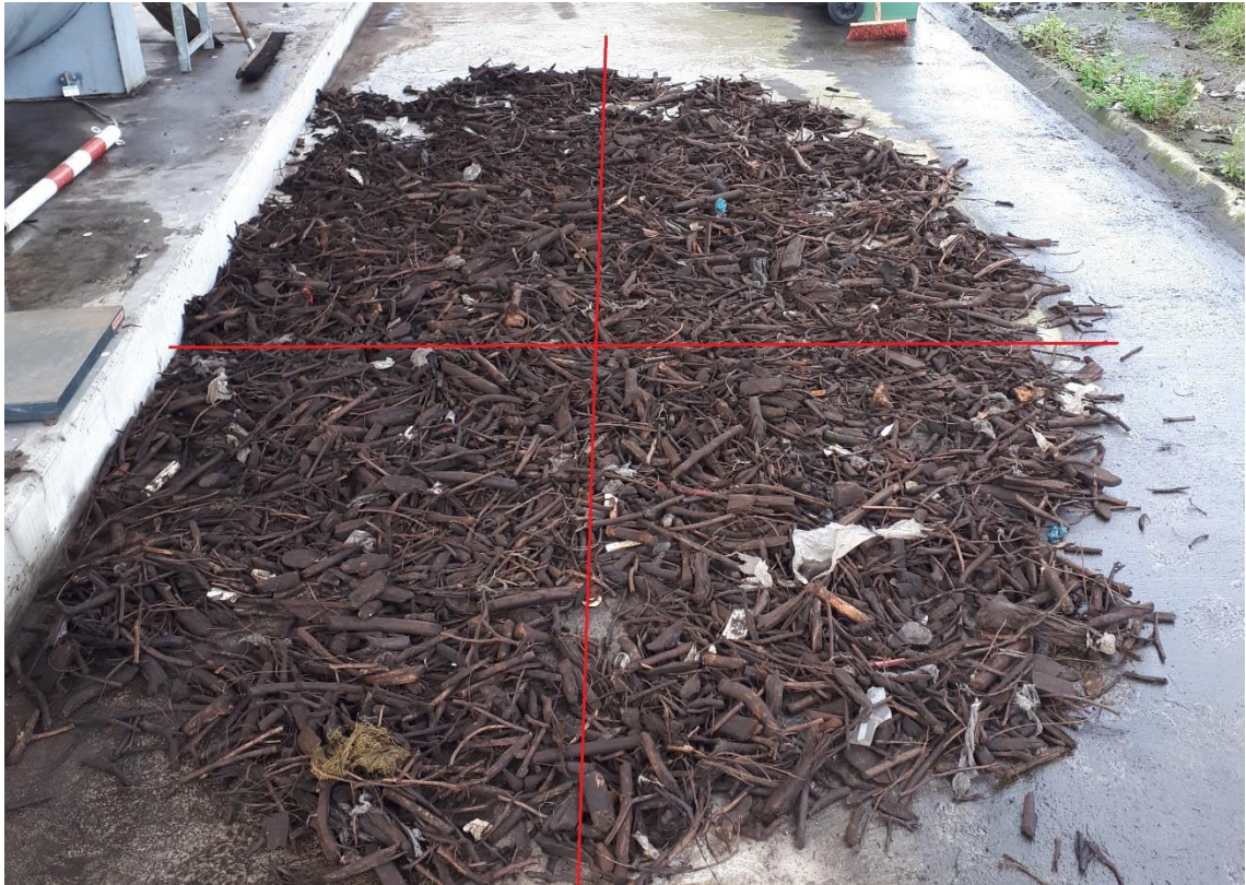
Abbildung 3-3: Viertelprobe des Siebüberlaufes; Störstoffe deutlich zu erkennen
