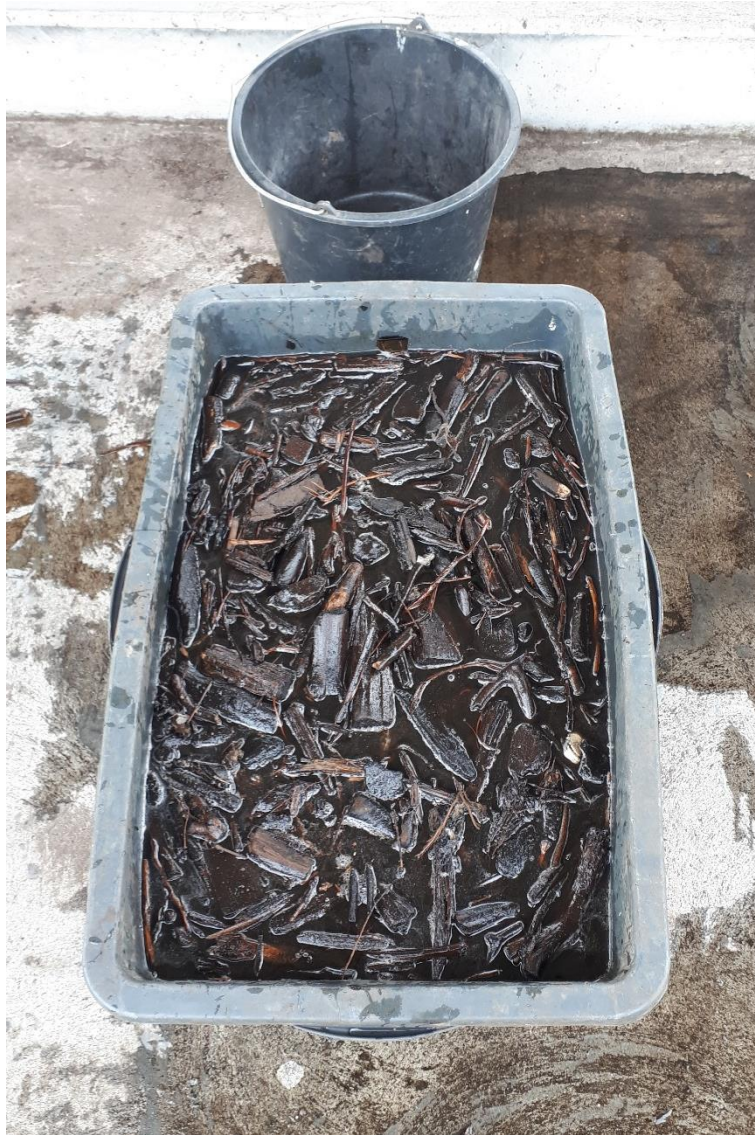
Abbildung 3-7: Simulation der Schwimm-Sink-Trennung von Siebüberlauf
