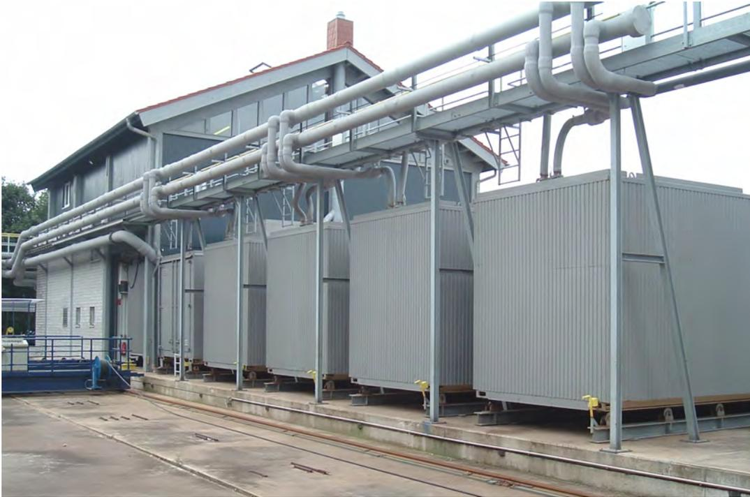
Druckbelüftete, wärmisolierte Rottecontainer
