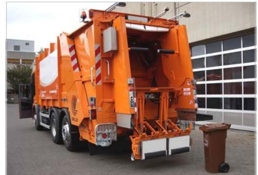
**Abbildung 1: Sammelfahrzeug mit eingebauten Störstoffdetektoren an der Schüttung.**
