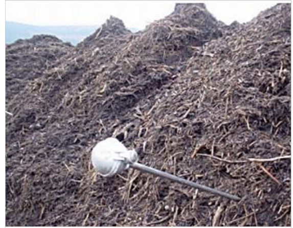
Abbildung 1: Temperaturmessung in der Miete
