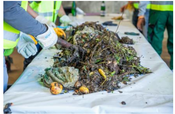
Sortierung einer Portion der Stichprobeneinheit auf dem Sortiertisch (4 Biertische mit Silofolie abgedeckt)
