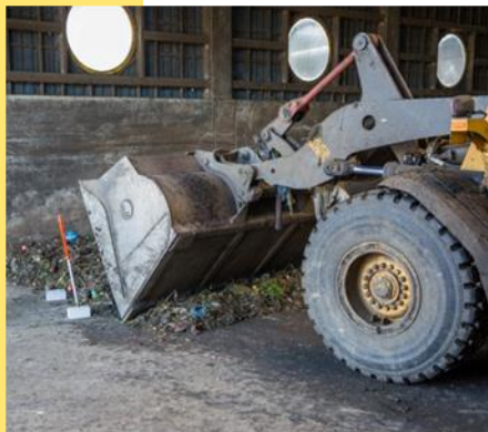
Radlader bei der Entnahme von Einzelstichproben aus der ausgebreiteten Charge
