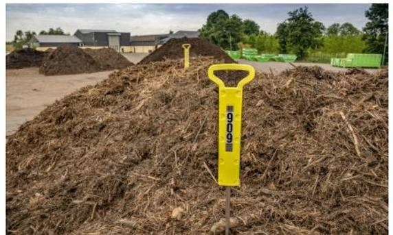
Das System eignet sich für die offene Mietenkompostierung und die meisten geschlossenen Verfahren gleichermaßen. Messlanzen werden in Längen von 1 m und 2 m angeboten.
