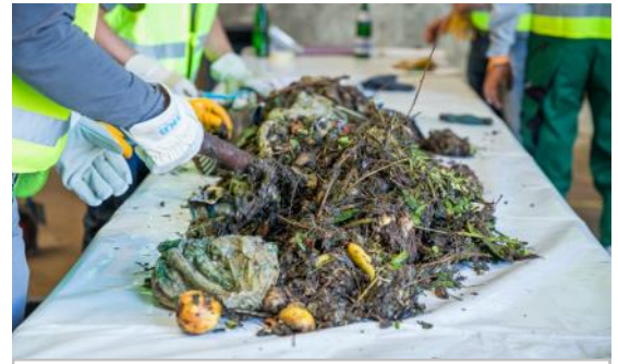
Sortierung einer Stichprobeneinheit.
